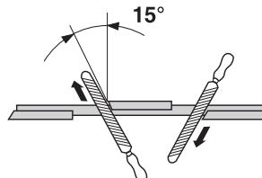
Отрегулируйте разводку. Она должен составлять 1 мм.
