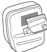
Если на вашем инструменте стоит глушитель такого типа, то сетку следует очищать не реже одного раза в неделю. На глушителях с катализатором, такую очистку достаточно производить раз в месяц. При возникновении повреждений на сетке ее следует заменить. Если сетка часто бывает засорена, значит функция катализатора ухудшена. Обращайтесь к вашему продавцу за советом. Засорение сетки вызовет перегрев двигателя и повреждение цилиндра и поршня.
