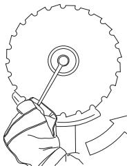
При ослаблении и затягивании гайки лезвия для пиления, рука может быть травмирована зубьями лезвия. Страйтесь, чтобы при этой работе ваша рука всегда была защищена щитком лезвия. Эта задача облегчается за счет использования длинного торцового ключа. На иллюстрации стрелкой показан участок, в котором следует располагать торцовый ключ при ослаблении и затягивании гайки.
