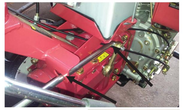
Выберите люфты в тросиках сцепления, и подачи топлива, если необходимо. Для этого используйте резьбовые втулки с контргайками на концах тросов. Выжим сцепления должен быть четкий, Вы должны чувствовать, что преодолеваете сопротивление пружины механизма сцепления.
