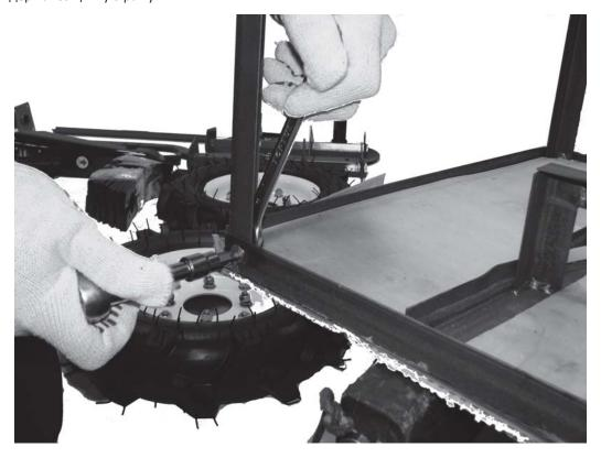
2. Начните сборку с колес (1). Выкрутите из каждого колеса по четыре ближних к центру болта. Возьмите валы (13) и прикрутите их к колесам, используя ключ на 16 и выкрученные ранее болты. Обратите внимание, что колеса имеют направленный протектор.
