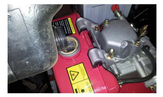
2. Заливка масла в фильтр. Установите культиватор горизонтально на ровную поверхность. Демонтируйте крышку фильтра. Залейте свежее масло в корпус воздушного фильтра как показано на фото. Объем—ок. 100мл. Используйте любое моторное масло, например автомобильное. В дальнейшем, по мере загрязнения меняйте масло в фильтре на свежее.
