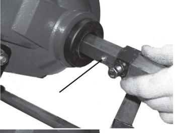
Установите крепление защитных шайб. Болты должны попасть в углубления на выходном валу.
